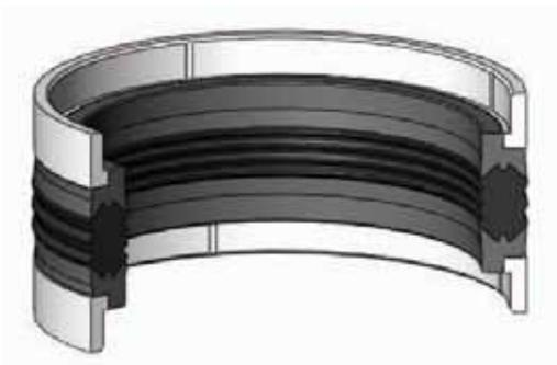
K42是五件套的雙向組合封，由一個多唇丁腈橡膠密封環、兩個用來防止密封間隙擠出的聚氨酯彈性體和兩個熱塑性塑料的導向環組成。
