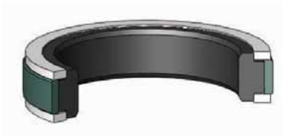
K19是雙向重載活塞封，由一個聚四氟乙烯+青銅環，一個丁腈橡膠預載密封環和兩個熱塑性塑料承托環組成。
