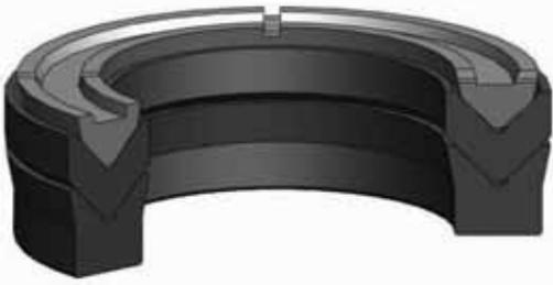
K03是單向活塞封，由1個夾織物承托環，1個丁腈橡膠中間環和一個熱塑性塑料頂環組成。
