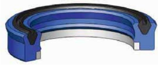
K31是由1個聚氨酯主密封元件、1個橡膠驅動體和1個聚甲醛承托環組成的單向活塞封。
