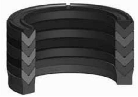
K01是7環單向密封組，由一個夾織物承托環、一個熱塑性塑料頂環、三個夾織中間環和兩個丁腈橡膠中間環組成。
